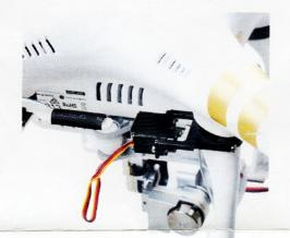
按以上方法将收放起落架成品与精灵3机身和脚架连接好,注意指南针模块 安装方向务必和图示一致,否则会导致无法校准或者不能正常飞行
