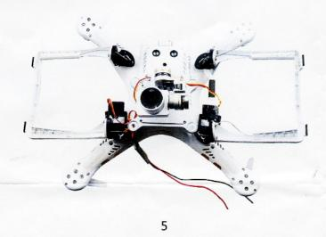
给起落架通电,通电后如图所示为正常工作状态可以飞行了,如起落架朝反方向运动请断电后互换控制器上1号和2号舵机的插头
